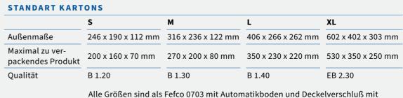
Alle Größen sind als Fefco 0703 mit Automatikboden und Deckelverschluß mit Selbstklebestreifen und Aufreißfaden oder als Faltkiste Fefco 0201 erhältlich.
