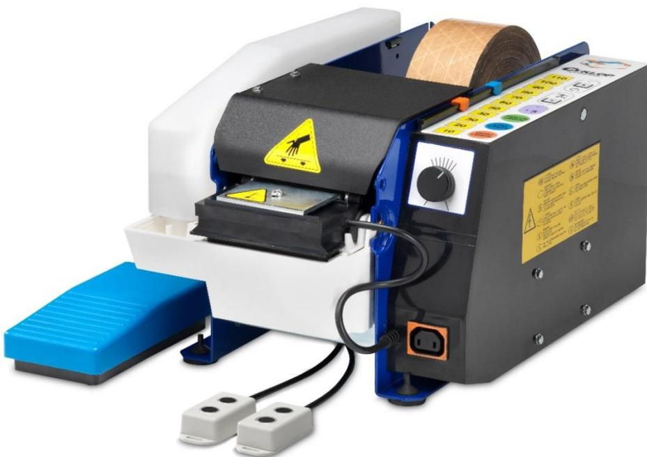
Der neue Nassklebebandspender Lapomagic erkennt mit Hilfe zweier Sensoren automatisch die Abmessungen des Verpackungskartons. Ein Tritt auf das Fußpedal genügt und die Lapomagic spendet die aktuell und für den Versandkarton benötigte Streifenlänge. Durch diese Arbeitsweise wird der Materialabfall reduziert und die Effektivität des Arbeiters um bis zu 20 % gesteigert.
